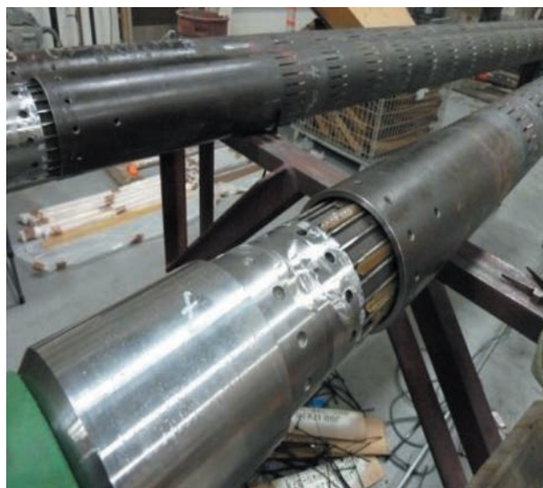
Рис. 2. Установка полимерных матриц с индикаторами притока в патрубок
