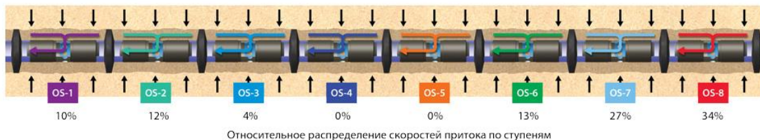
Рис. 1. Расположение восьми систем RES•OIL в каждой ступени горизонтальной скважины с многостадийным ГРП
